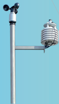
RTG-Kontrollstation mit Klimasensorik (1802200)
