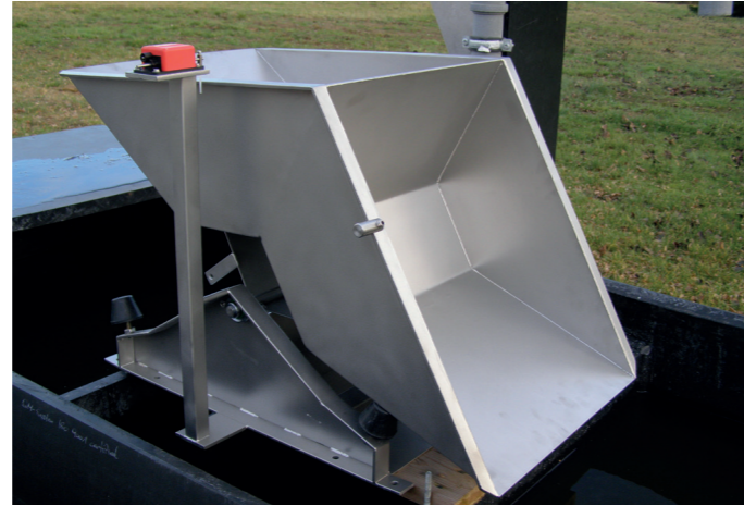
KIPPZÄHLER - zur zeitlich hochaufgelösten Erfassung von Sickeraten und Durchflüssen aus PE oder V2A-Stahl. Kippchalengrößen 0,1 l und 20 l mit Datenlogger und adäquater Probenahme.
