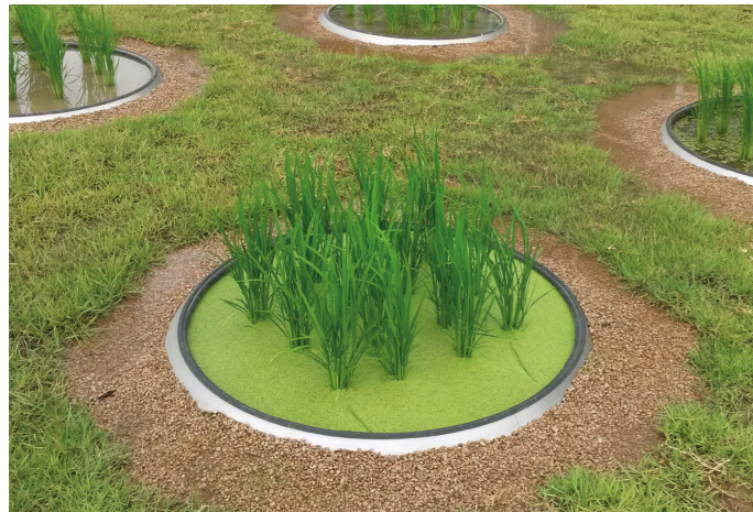
LYSIMETER - zur Erfassung der realen Evapotranspiration und aller Wasserhaushaltsgrößen. Verschiedene Größen für Labor und Freiland, mit/ohne Atmosphäreinheit, Sensorik und Design auf Ihre Anwendung abgestimmt.
