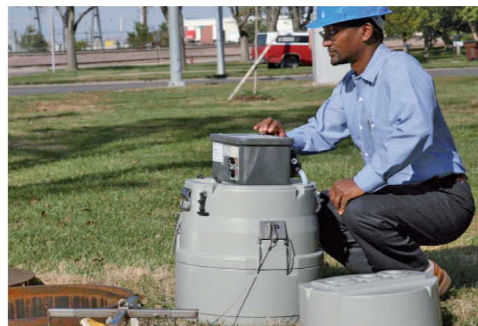
PROBENNEHMER - von Teledyne ISCO. Mobil oder festinstalliert, für Einzel- oder Mischproben nach Zeit, Durchfluss oder Ereignis.
