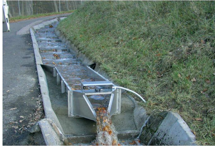
H-FLUME - zur berührungslosen Durchflussmessung an offenen Gerinnen. Auch bei stark variierenden Fließraten und für verschmutztes Wasser. Ganzjährige Messung, wartungsarm.
